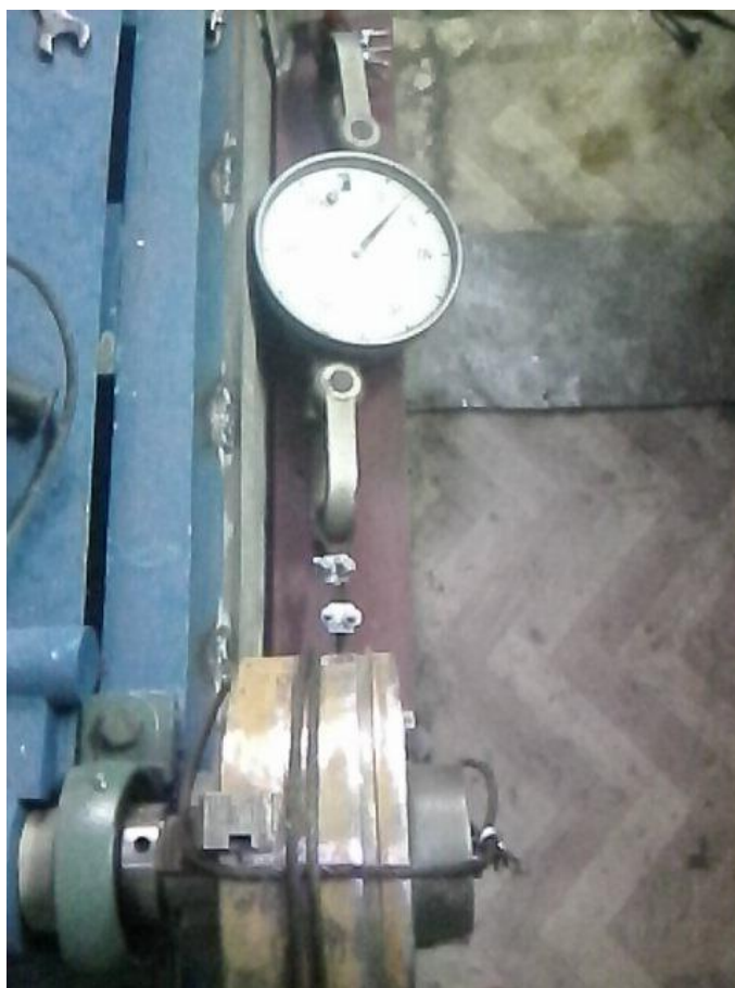
Рисунок 4.4 – Приставка для определения крутящего момента, создаваемого приводом
