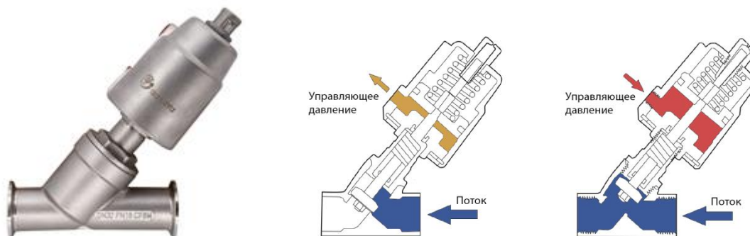
Рисунок 3.5 – Пневмуправляемый клапан
